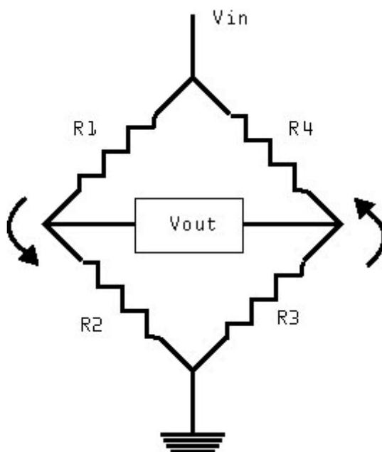
Cuando el voltaje en  $V_a$  y  $V_b$  son iguales.  $V_{out}$  es igual a cero, En este punto recordemos entonces que el puente está balanceado. Entonces el valor de  $R_4$  lo podemos encontrar a partir de la relación:
