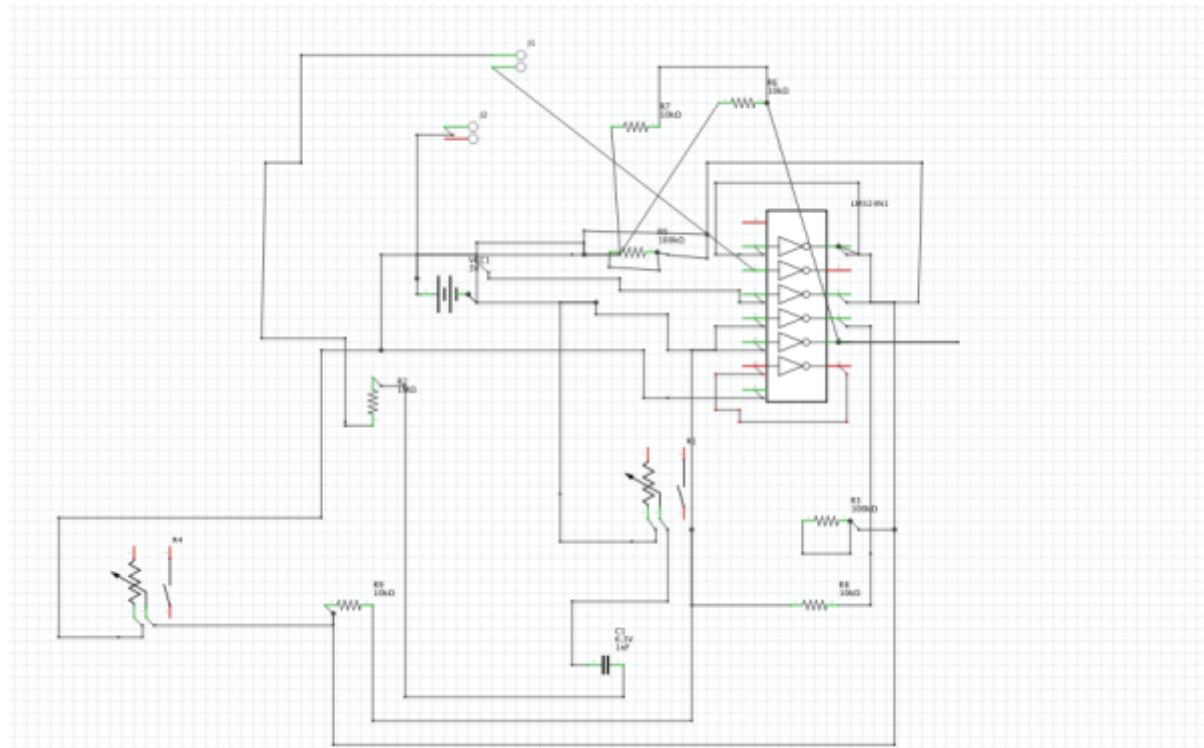
La parte de preamplificación, esta integrada por un circuito galvanico, diseñado a partir del amplificador operacional LM324N
