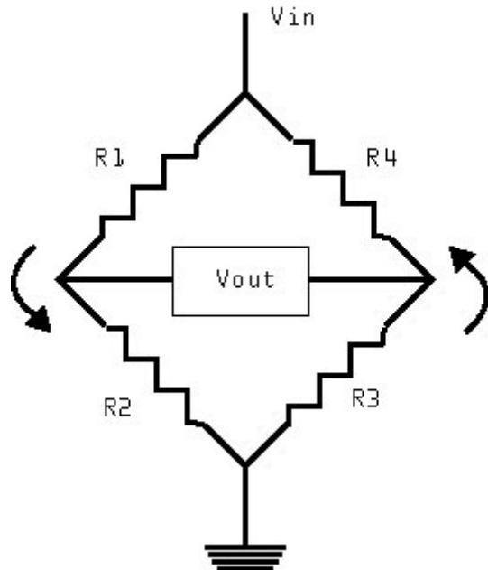
Cuando el voltaje en  $V_a$  y  $V_b$  son iguales.  $V_{out}$  es igual a cero, En este punto recordemos entonces que el puente esta balanceado. Entonces el valor de  $R_4$  lo podemos encontrar a partir de la relación:
