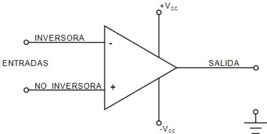
Los amplificadores operacionales son dispositivos pequeños muy prácticos en la electrónica, que tienen dos entradas y una salida. El símbolo de un amplificador operacional es un triángulo en el circuito esquemático. Estas entradas por lo general están en la parte vertical del triángulo, etiquetadas como:
