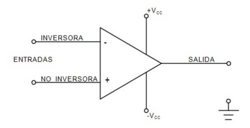
Los amplificadores operacionales son dispositivos pequeños muy prácticos en la electrónica, que tienen dos entradas y una salida. El símbolo de un amplificadores operacional es un triángulo en el circuito esquemático. Estas entradas por lo general están en la parte vertical del triángulo, etiquetadas como:
