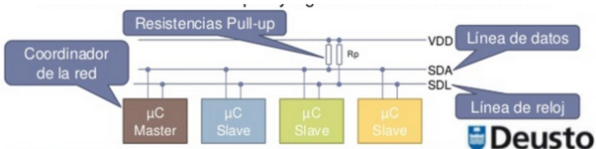
Solo utiliza dos líneas para transmitir datos (SDA) y la señal de reloj (SCL)
