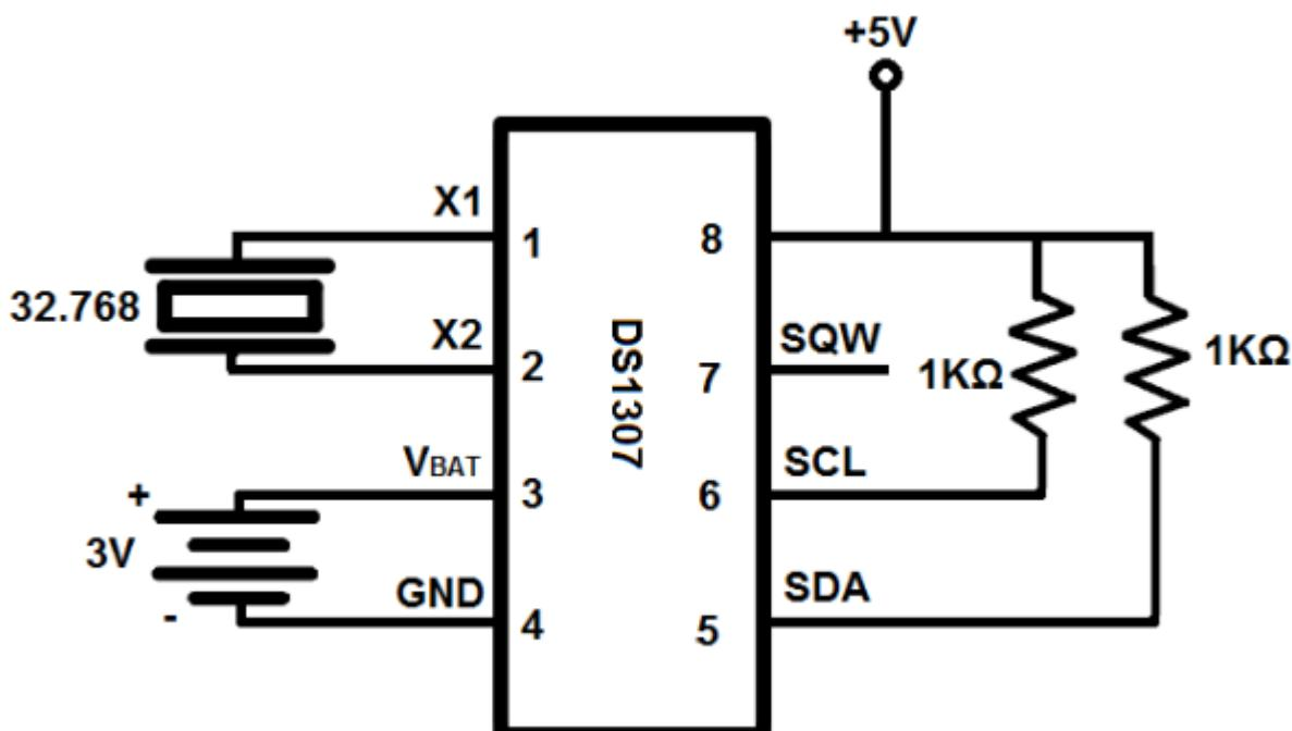
RTC o Reloj en Tiempo Real - Es un circuito electrónico especializado cuya función es mantener la hora y fecha actual en un sistema informático (ya sea con microcontrolador u otro tipo de CPU). Se caracteriza por tener un bajo consumo de energía y también normalmente su propia fuente de
