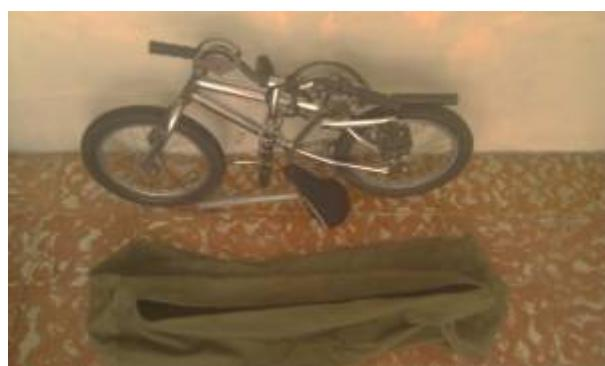
Aca se muestra como se puede plegar sus “extremidades superiores” la parte de la dirección y la parte del tubo del asiento, al punto de guardar en un morral y ser transportado para largos viajes o para guardar en espacios reducidos, cuartos utiles.
