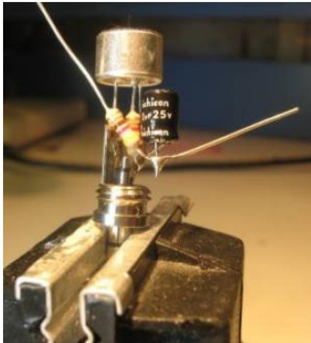
A continuación, soldar el otro extremo de la resistencia de 470ohm a la almohadilla de drenaje en el micrófono.
