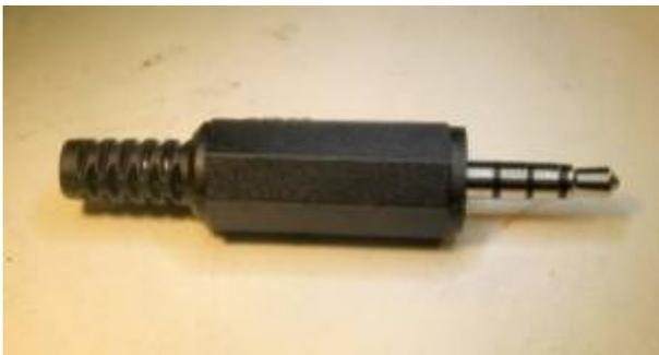
El "jack 1/8 utilizado para el bootlegMIC tiene 4 anillos conductores en él, que es estándar para la mayoría de los teléfonos celulares. Si desea utilizar el bootlegMIC con un ordenador u otro dispositivo de grabación, se necesita un conector de 3 pines o 2. El montaje es el mismo en ambos casos, ya que sólo utiliza 2 de los conductores de todos modos. En primer lugar, desenroscar y quitar la carcasa de plástico.
