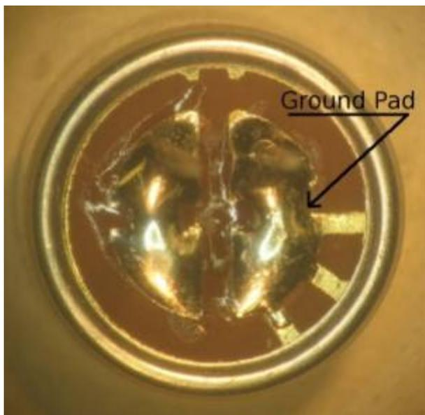
Tendrá que cortar la placa de tierra a la mitad, por lo que el lado con el pasador está completamente desconectado de la parte con restos de tierra. Para ello, utilice una hoja de afeitar afilada, y cortar 2 rebanadas, muy próximas entre sí, entre las almohadillas.
