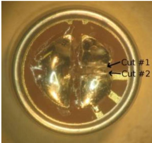
Seguir investigando los 2 cortes más profundo con la cuchilla de afeitar, y es muy probable que limpiar un pequeño canal entre las 2 almohadillas. Se puede ejecutar un pequeño destornillador de ida y vuelta en el canal para deshacerse de cualquier cobre o soldadura que pueda quedar allí. Sólo para estar seguro de que se separaron por completo las 2 almohadillas, se puede usar un multímetro para medir la resistencia entre ellos, lo que debe decir circuito abierto.
