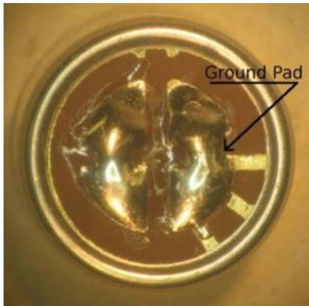
Tendrá que cortar la placa de tierra a la mitad, por lo que el lado con el pasador está completamente desconectado de la parte con restos de tierra. Para ello, utilice una hoja de afeitar afilada, y cortar 2 rebanadas, muy próximos entre sí, entre las almohadillas.
