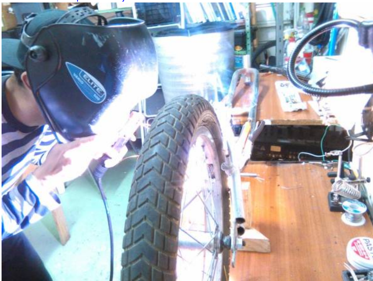
El eje se sacó de una impresora vieja donde van los rodillos.
