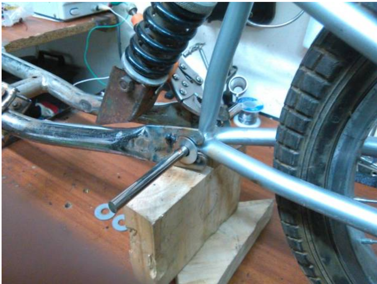
El eje se sacó de una impresora vieja donde van los rodillos.
