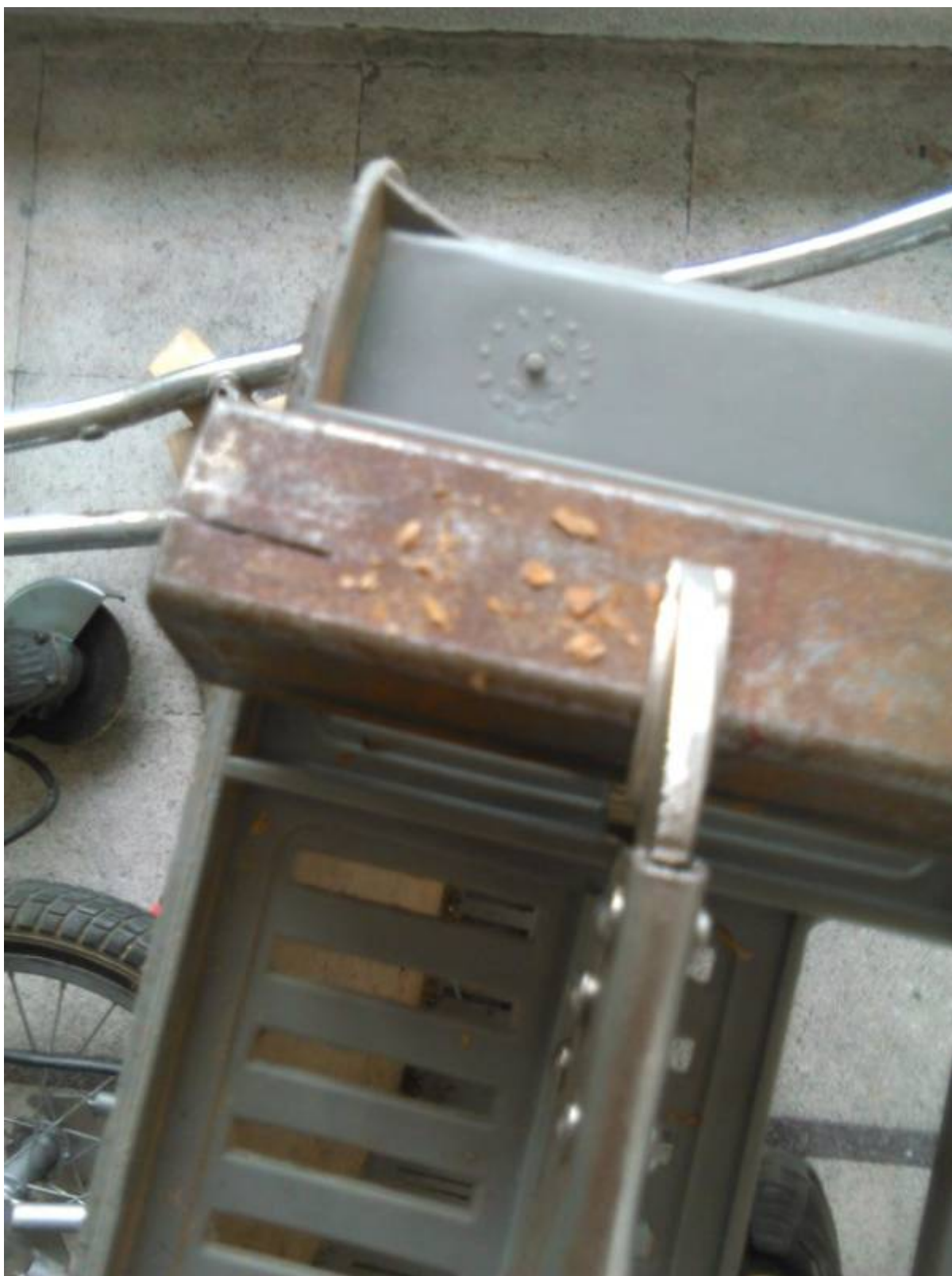
Esta pieza se corto para poder cerra mas esa zona donde se instalara posteriormente el pasador inferior de la tijera de bicicleta.
