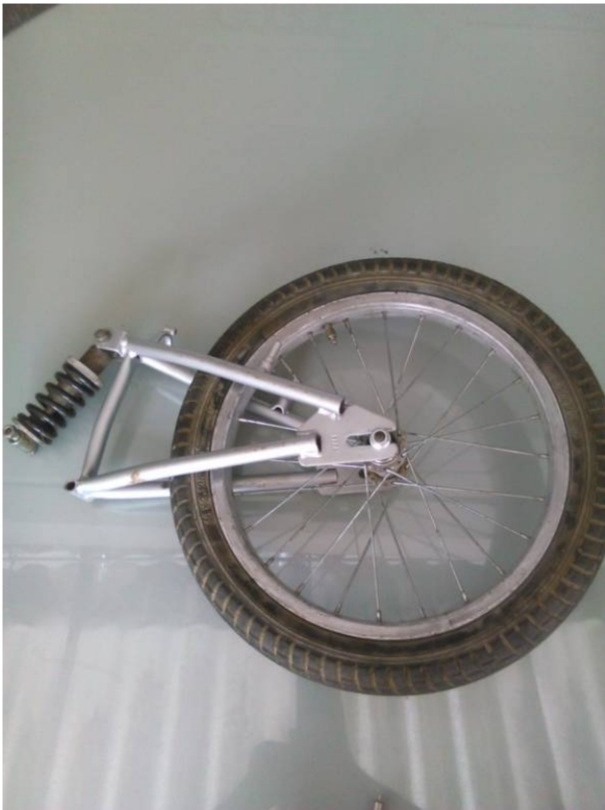
La tijera y suspencion fueron tomadas de una bici de niño Rin 16"
