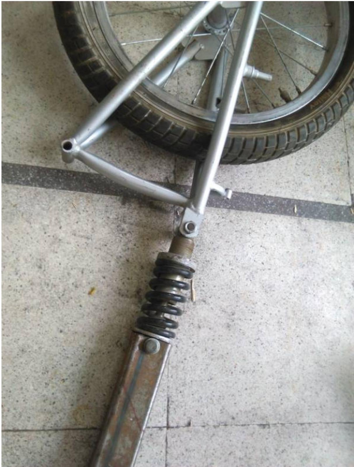
Una vez marcado y presentado se dispuso a cortar el angulo medido y trazado para despues soldarlo al chasis.
