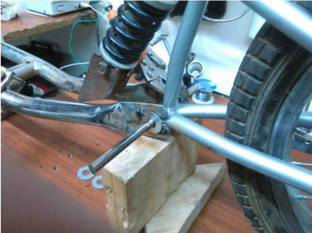
El eje se saco de una impresora vieja donde van los rodillos.
