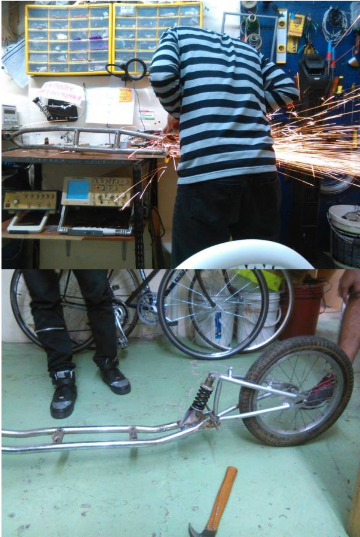
Suspension y tijera soldadas al chasis de el monopatín.
