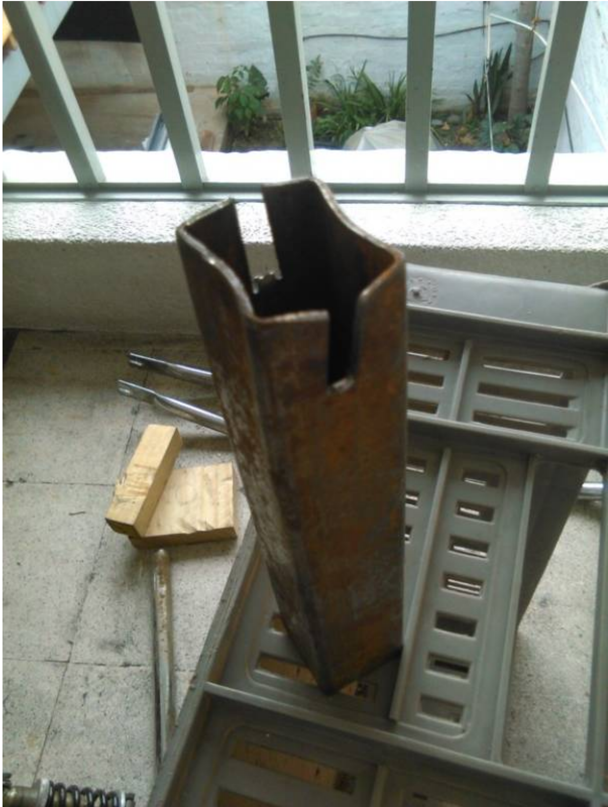
Esta pieza se diseño para unir la otra parte de la tijera al chasis en donde va la suspensión.
