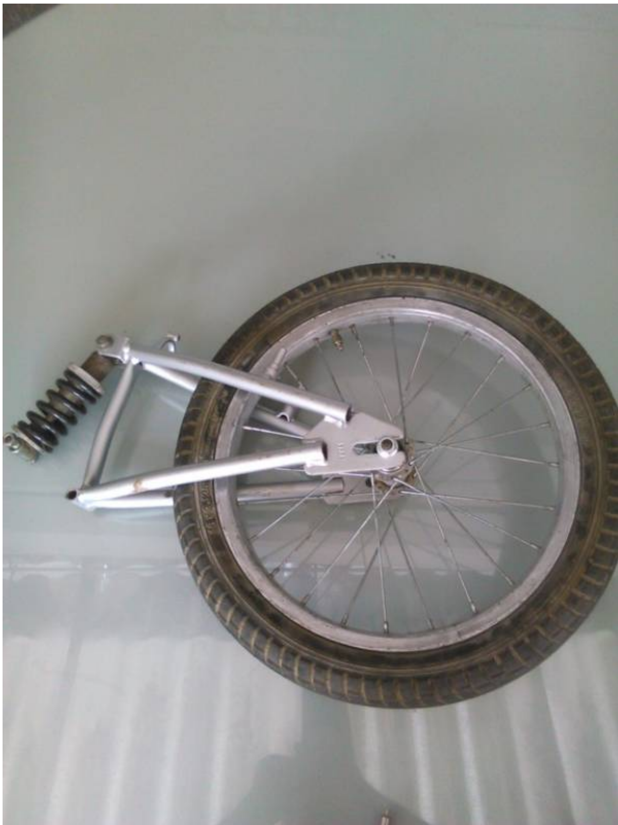
La tijera y suspenion fueron tomadas de una bici de niño Rin 16"
