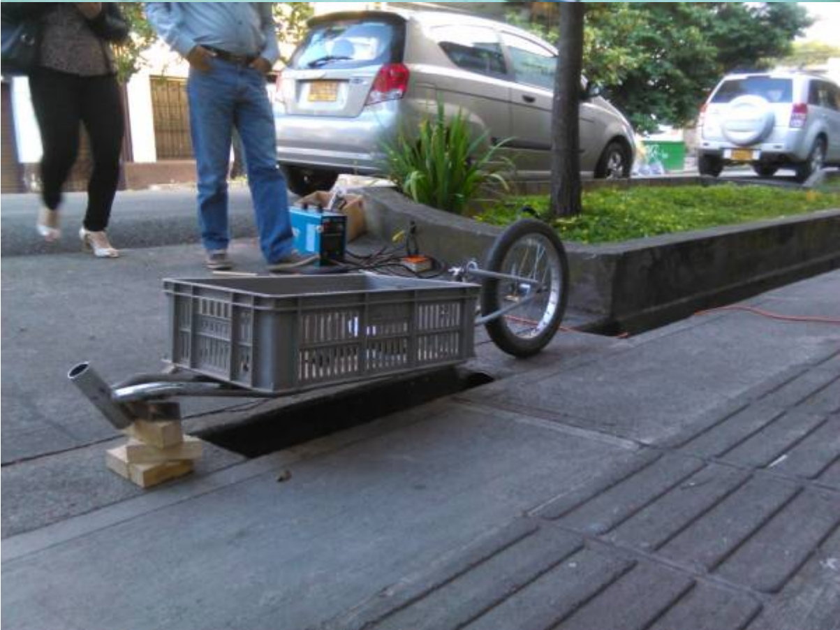
En la parte frontal del trailer, se dara más ángulo vertical lo cual se necesita para una buena dirección.
