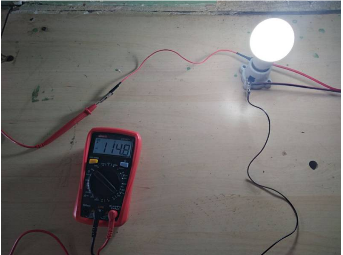
voltage rms de salida a la carga cuando esta apagado
