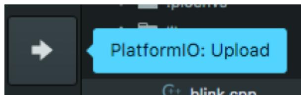
Es muy importante no olvidar que en el proceso de upload del codigo, se debe presionar el botón **flash** de ESP para que el código pueda pasar y es normal que se demore un poco la carga.
