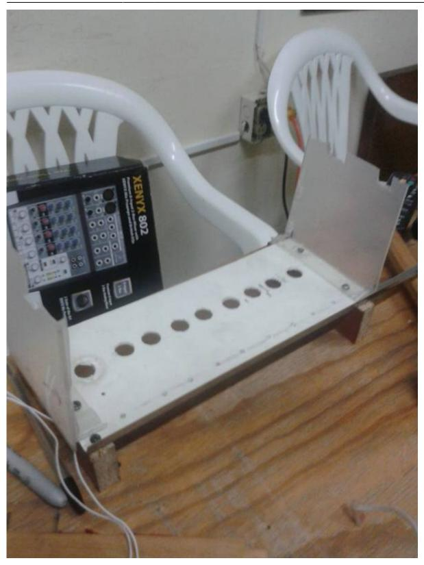
Para llevar a cabo este proceso se experimenta con varios modelos, alturas y voltajes que llegan a los actuadores hasta encontrar la posicion ideal. Posteriormente se construye un circuito electronico que permite accionar cada percutor y este a su vez; es controlado electricamente por un microcontrolador(Arduino).
