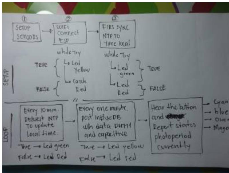
Resumidamente cuando se trata de conectar el led parpadea amarillo, si falla entonces parpadeara rojo. Luego hara el request al NTP para sincronizar el timeAlarms y setear la alarma inicialmente. En este proceso el led parpadeara verde, si falla parpadeara rojo.
