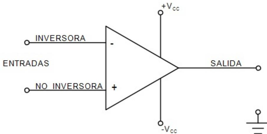
Los amplificadores operacionales son dispositivos pequeños muy prácticos en la electrónica, que tienen dos entradas y una salida. El símbolo de un amplificadores operacional es un triángulo en el circuito esquemático. Estas entradas por lo general están en la parte vertical del triángulo, etiquetadas como:
