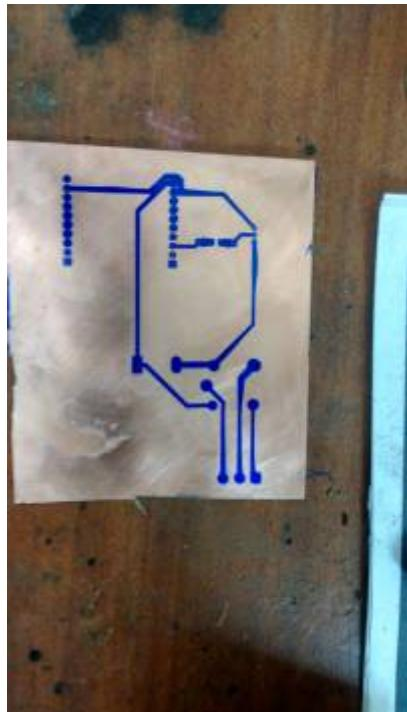
4. Por ahora este es el mejor resultado luego de pasar por el revelado y antes del cloruro, continuamos probando entre el software de diseño y la fijación en el cobre para dar con los espacios mínimos entre tracks, anchos, tamaños de vías, etc... y la nitidez con la que estamos revelando
