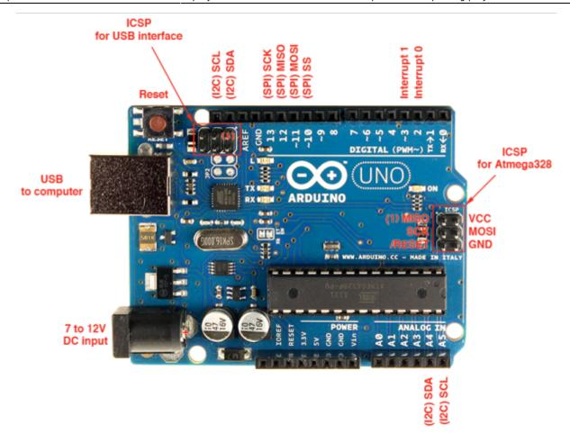
Hiduino es un firmware del chip Atmega16U2 que permite que la placa Arduino sea reconocida por computadores como dispositivos HID, es decir; teclados, mouses y perifericos conectados al computador. (human interface device)
