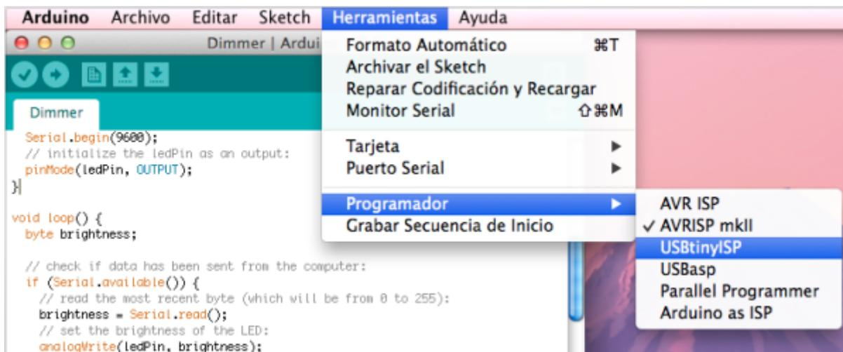
Cuando este código en software esta listo, procedemos a conectar el programador ISP y luego abrimos la interfaz de Arduino, es muy importante elegir el programador a usar, porque ya no estamos usando la interfaz USB. Para seleccionar el programador adecuado, por favor mire la imagen de arriba.
