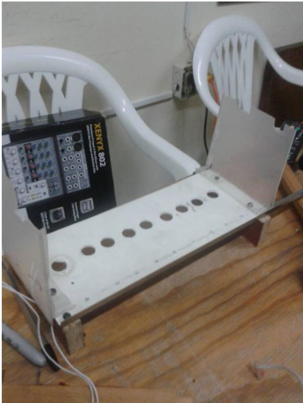
Para llevar a cabo este proceso se experimenta con varios modelos, alturas y voltajes que llegan a los actuadores hasta encontrar la posición ideal. Posteriormente se construye un circuito electrónico que permite accionar cada percutor y este a su vez; es controlado eléctricamente por un microcontrolador(Arduino).
