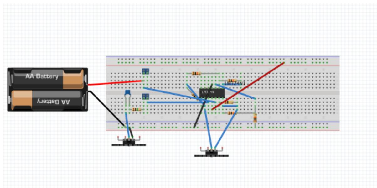
La parte de preamplificación, esta integrada por un circuito galvanico, diseñado a partir del amplificador operacional LM324N
