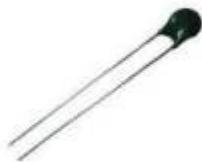
Para utilizar un termistor sencillo vamos a calibrarlo utilizando la ecuación [Steinhart-Hart](#) [ampliar info sobre esta ecuacion?](#)
